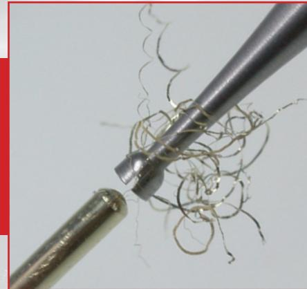
La fraise creuse BUSCH à « excellente » géométrie de lame TWINCUT pour un fraisage précis et rapide.
